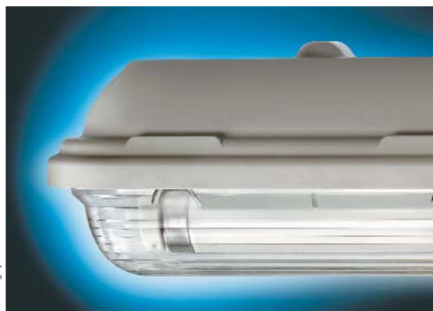
Luminária fluorescente com grau de proteção IP 66 (protegida contra penetração de pós e contra fortes jatos d'água)
